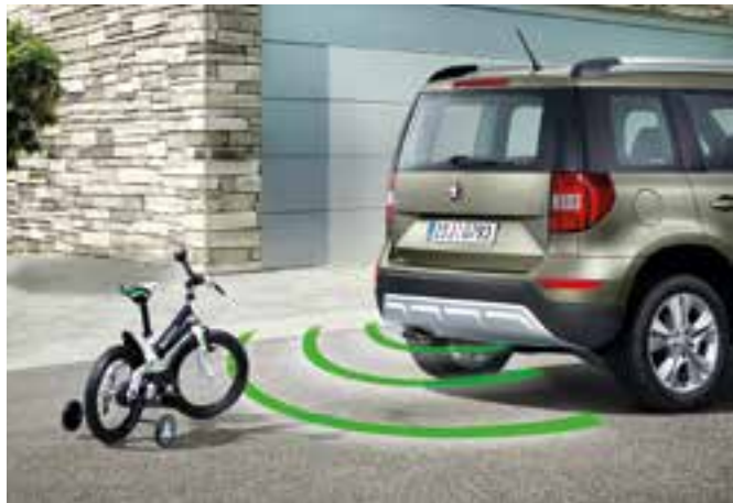
Zadní parkovací senzory hlídají vzdálenost vozu od případné překážky. Objeví-li se překážka ve vzdálenosti 140 cm od zadní části vozu, je signalizována krátkými pípnutími v intervalu 1 sekundy. Tento interval se plynule zkracuje s přibližováním se k překážce. Při přiblížení na 30 cm přejde pípání v souvislý tón (BKA 600 003A)
