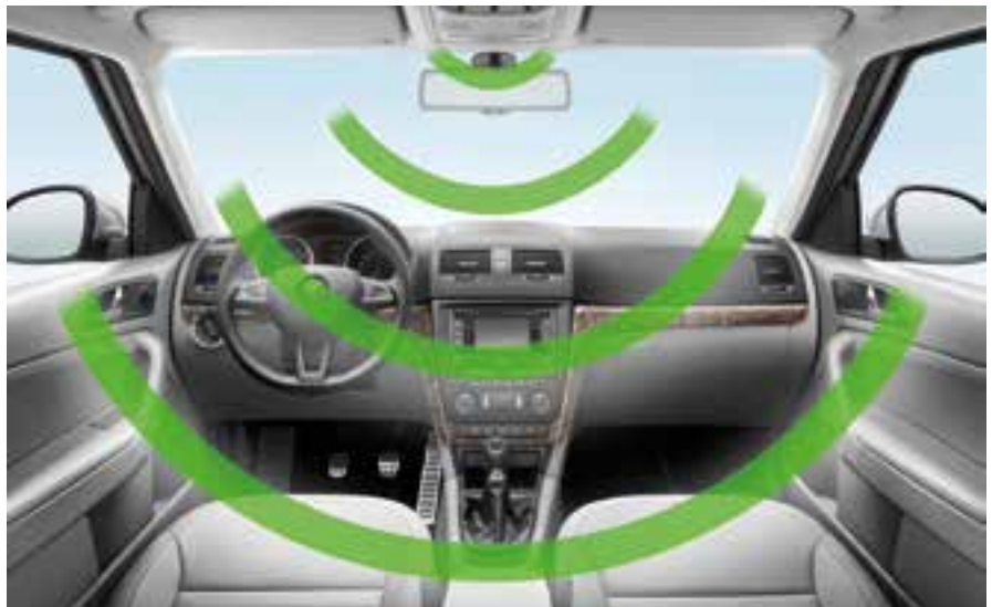
Alarm s hlídáním vnitřního prostoru je vybaven zálohovým zdrojem, který zajistí funkčnost systému i po odpojení baterie. Aktivuje se automaticky po uzamčení vozu a monitoruje všechny dveře, víko motoru, spínací skříňku a vnitřní prostor vozidla. Jestliže dojde k nedovolenému zásahu, uvede řídicí jednotka v činnost všechna směrová světla a sirénu. Zvukový alarm trvá 25 vteřin a může být vyvolán opakovaně až 10x za sebou. Základní sada alarmu pro vozy se sériovým dálkovým ovládáním centrálního zamykání (BKA 700 001); základní sada alarmu pro vozy bez dálkového ovládání centrálního zamykání (BKA 700 002); montážní sada pro alarm (BKA 630 001)
