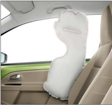
Vedle airbagů řidiče a spolujezdce představují standardní výbavu vozu speciální boční airbagy Head-Thorax , které dokážou v případě bočního nárazu ochránit hlavu i trup pasažérů na předních sedadlech.
