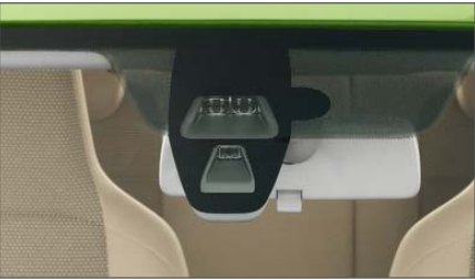
Pro bezpečnější jízdu především v plných městských ulicích Vám nabízíme systém City Safe Drive s funkcí nouzového brzdění. Součástí systému je senzor CV (Closing Velocity), který sleduje prostor před vozidlem na vzdálenost 10 m a při rychlosti do 30 km/h. V případě, že řidič včas nereaguje na překážku, může systém zabránit kolizi.
