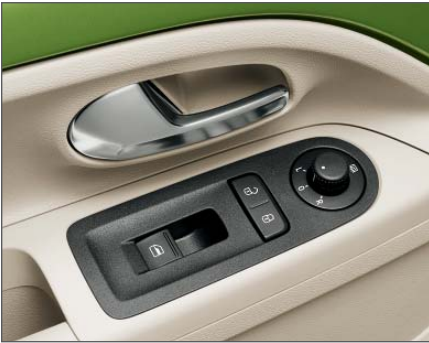
V závislosti na výbavě vozu může mít řidič po ruce ve svých dveřích hned několik ovladačů : elektrické ovládání okna řidiče, ovládání centrálního zamykání z interiéru vozu, elektrické ovládání a vyhřívání vnějších zpětných zrcátek.
