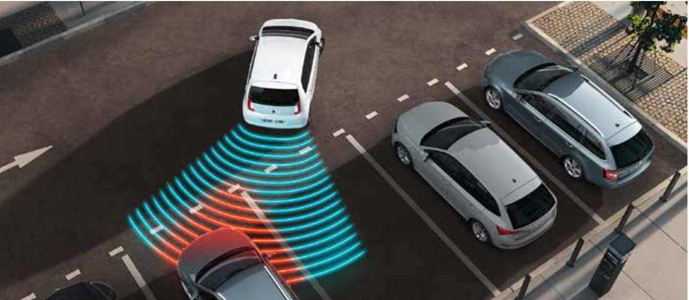
SIGNALIZACE VZDÁLENOSTI PŘI PARKOVÁNÍ Parkování s modelem CITIGO ® iV je snazší a bezpečnější díky parkovacím sensorům integrovaným do zadního nárazníku. Sensory kontrolují vzdálenost vozu od jakékoliv překážky.
