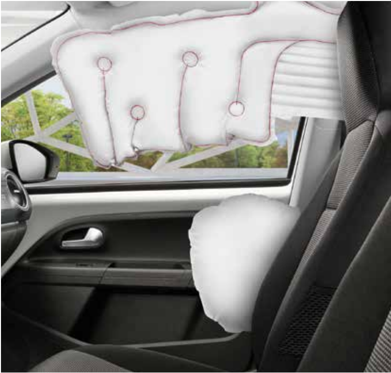
BOČNÍ AIRBAGY Standardní výbavou vozu jsou také speciální boční airbagy Head-Thorax, které dokážou v případě bočního nárazu ochránit hlavu i trup pasažérů na předních sedadlech.
