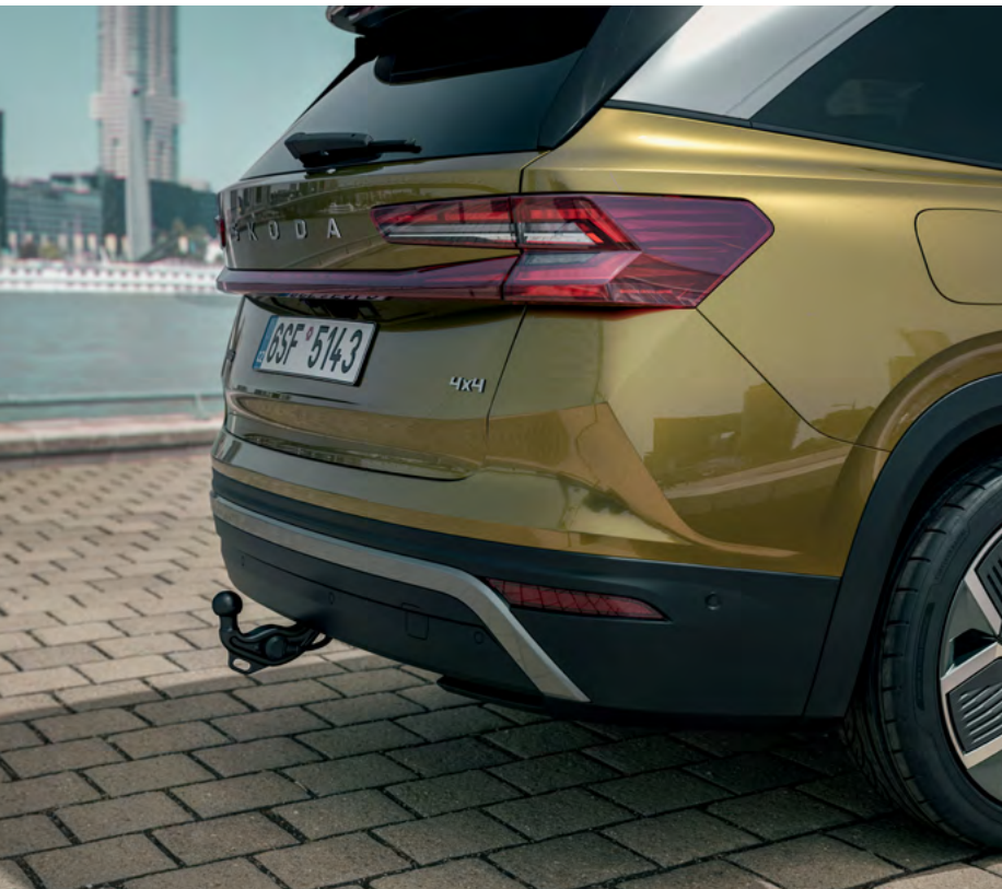
Tažné zařízení sklopné, elektricky odjistitelné
