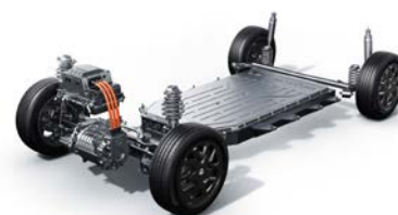
Umístění trakční baterie v podlaze vozu
