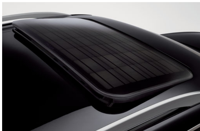
Střešní okno se solárním panelem.
