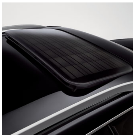
Střešní okno se solárním panelem. St Sp
