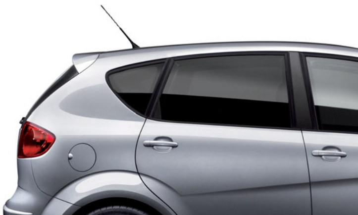
Tmavá okna od sloupku B.
