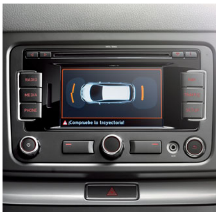
Parkovací senzory vpředu a vzadu ukazují na displeji SEAT sound systému aktuální situaci za vozidlem.
