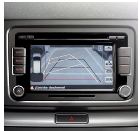
Parkovací asistent vyhledá vhodné parkovací místo a automaticky převezme řízení během parkovacího manévru.
