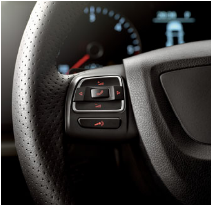
Tlačítka na multifunkčním volantu můžete ovládat SEAT sound systém spolu s handsfree Bluetooth.
