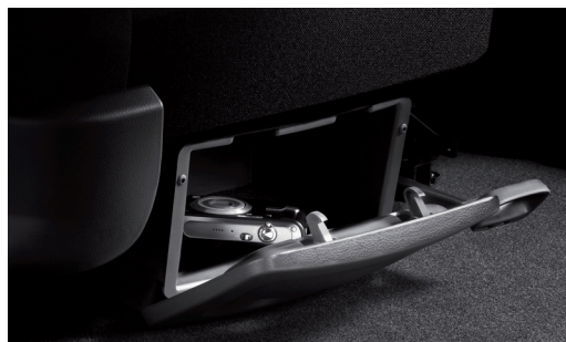
▼ Odkládací schránka pod sedadlem řidiče (zahrnuta v paketu „Schránky“ a dodávaná pro model Ibiza ST)
